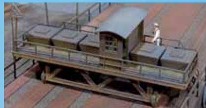
Kohle-Befüllwagen für Ofenbatterie
