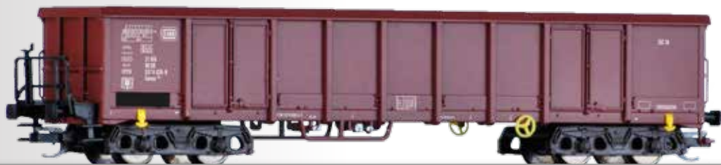
Offener Güterwagen Eanos 052 der DB Open car Eanos 052 of the DB • Mit Bremserbühne / With platform
