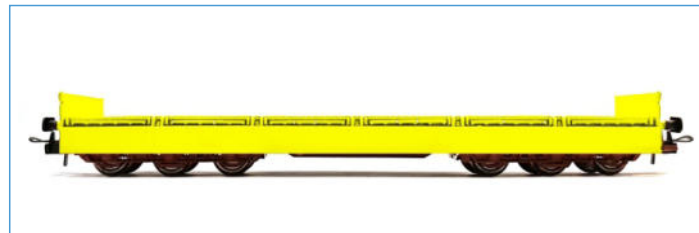
6-achsiger Bauzugwagen der Bahnbau Gruppe Bauart Samms-u 454 der DB AG (Epoche VI) gelb-schwarz, abgeklappte Bordwände, unladen
