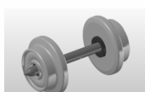
NZ 33282 Scheibenradsatz 9 mm Achsmaß 25,85 einseitig isoliert
