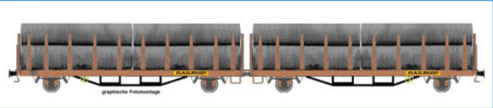
4achsige Flachwagen-Doppelereinheit Bauart Laas 1 der Fa. Railship eingestellt bei der DR (Epoche IV) rotbraun einfarbig, beladen mit großen Stahlrohren
