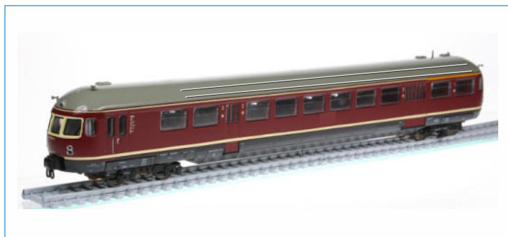
Akkutriebwagen ETA 176 002 (Epoche IIIa), Ursprungsausführung mit Dachrippen, Seitenlüfter, ursprüngliche Dachlüfter, 2-Licht-Spitzensignal
