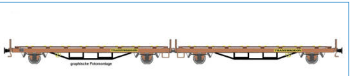
4achsige Flachwagen-Doppelereinheit Bauart Laas 1 der Fa. Transwaggon eingestellt bei der DB AG (Epoche V/VI) rotbraun einfarbig, unbeladen, mit Halter für Radfahrzeuge
