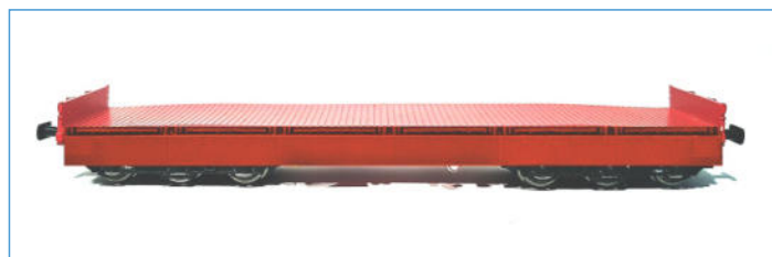
6-achsiger Schwerlastwagen Bauart Samms-u 454 der DB AG (Epoche V) verkehrsrot, abgeklappte Bordwänden, 1. Betriebsnummer
