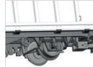
■ Filigrane Umsetzung der Achslager
