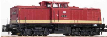
Modell der Diesellokomotive Baureihe 199.8 der HSB. Epoche 5. Schwarzes Fahrwerk. Ausführung mit beidseitigen Puffern und Regelspurkupplungen, um direkt an auf Rollböcken verladene Wagen kuppeln zu können.
