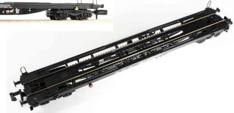
Beide Modelle sind mit elektrisch leitenden Gleisen ausgerüstet. Diese lassen sich über Kontakte am Ladegleis mit Spannung versorgen. Die Modelle können somit auch (nicht ganz vorbildgerecht) von Triebfahrzeugen mit eigener Kraft befahren werden.
