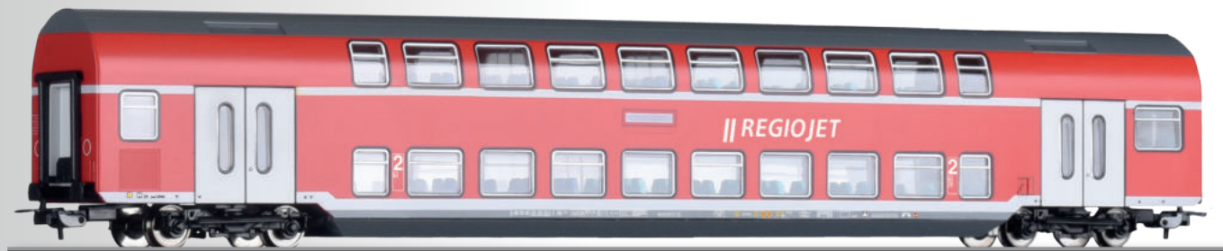
Doppelstockwagen 2. Klasse DBz750 der RegioJet 2nd class double-deck coach DBz750 der RegioJet
