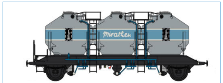
2-achsiges Silowagen Bauart Ucs der DR „Mirathen“ (Epoche IV) zum Transport von Kunststoffgranulaten, 2. Betriebs-Nr. NW 52019 DC 2L TT 49,90 €
