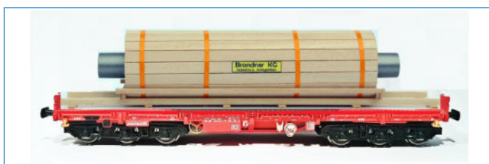
6-achsiger Schwerlastwagen Bauart Salmms 454 der DB AG (Epoche V) beladen mit Schredderwalze
