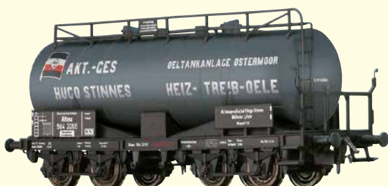
Kesselwagen 4-achsig ZZ [P] "Hugo Stinnes" DRG Betriebs-Nr. Altona 504 331 [P]
