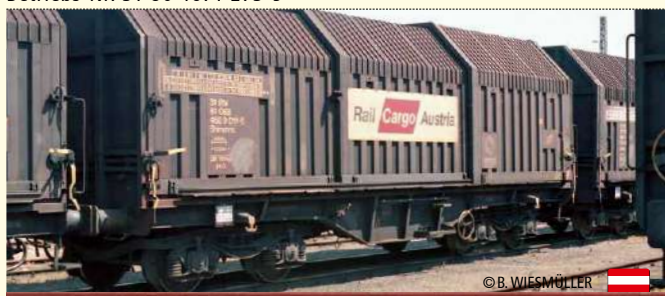
Teleskophaubenwagen Shimms ÖBB, Rail Cargo Austria Betriebs-Nr. 31 80 4671 273-9
