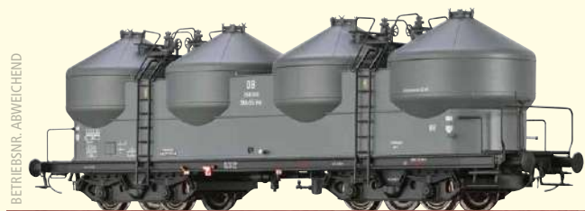
Staubbehälterwagen KKds 55 der DB Betriebs-Nr. 358 014
