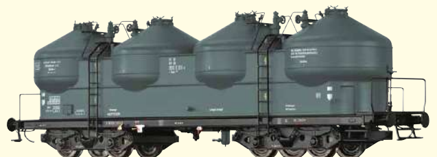
Staubbehälterwagen Uacs 946 der DB Betriebs-Nr. 31 80 930 5 011-6
