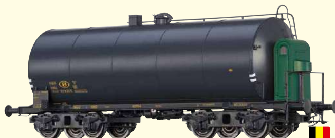
Leichtbaukesselwagen Uerdingen ZZ [P] der SNCB Betriebs-Nr. 921766
