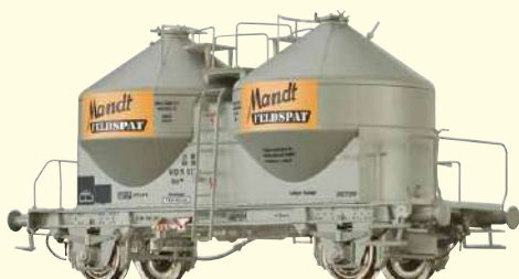
Staubbehälterwagen Ucs 908 "Mandt Feldspat" der DB Betriebs-Nr. 21 80 910 5 321-3
