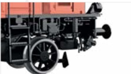
Aggregate und Leitungen freistehend ausgeführt
