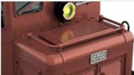
Freistehende Griffstangen und separat angesteckter Deckel am Vorbau
