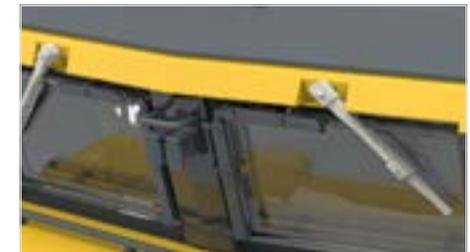
Angesteckte Scheibenwischer und Steckdosen
