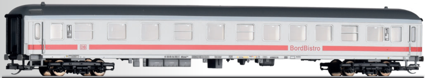
Reisezugwagen 1. Klasse mit BordBistro ARkimbz 266.5 der DB AG 1st class passenger coach with bistro ARkimbz 266.5 of the DB AG
