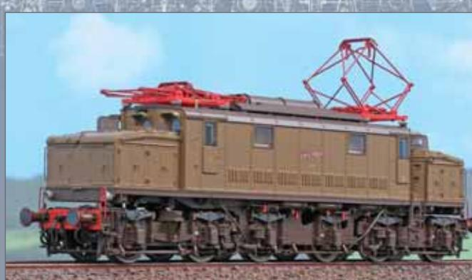
Locomotiva E. 626.313 del Deposito di Salerno, nello stato di servizio degli anni Ottanta, dotata di maglia sganciabile in corsa, utilizzata durante il servizio di spinta.
