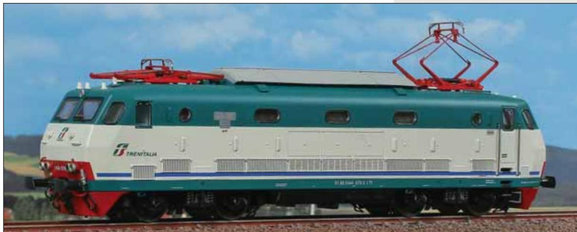
Locomotiva elettrica FS E.444R stato attuale, con conduttori a 13 poli per il comando laterizzato delle porte del treno.
