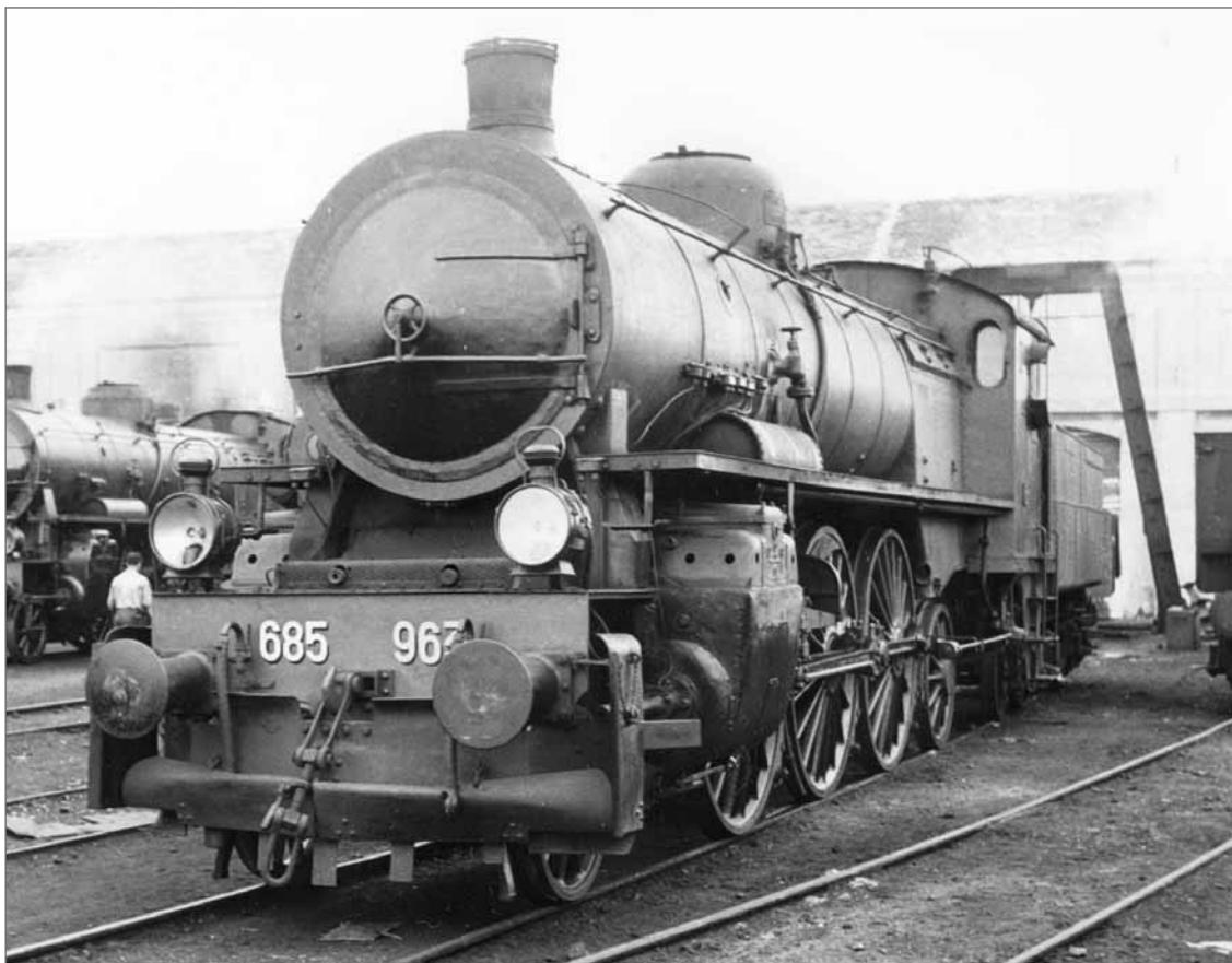
Locomotiva a vapore delle FS 685.963 (ex gruppo 686.005-034), con distribuzione Caprotti, costruite nel 1926/28 da OM e CEMSA. Il modello riproduce l' unità ex 686.013, nella condizione di fine carriera, assegnata al deposito di Udine.
